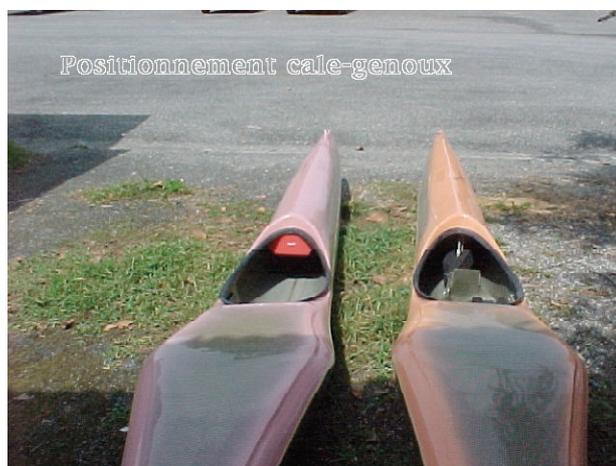
Coque : Carbone-Kevlar translucide, Verre, Airex, renfort Carb-Kev sous le pagayeur, renforts Kevlar étrave et talon.
